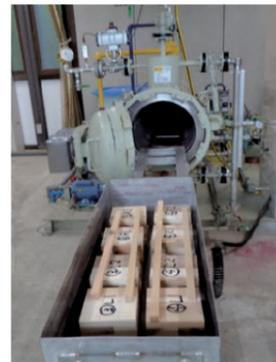
写真3 減圧加圧剥離試験
