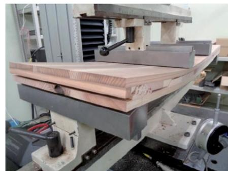
写真1 製品の曲げ試験
