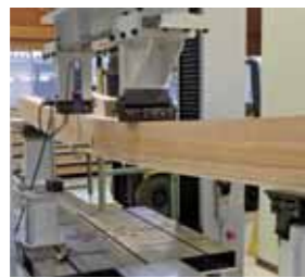
図3 曲げ試験の様子(これは木裏荷重)
