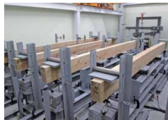
写真1 曲げクリープ試験の状況
