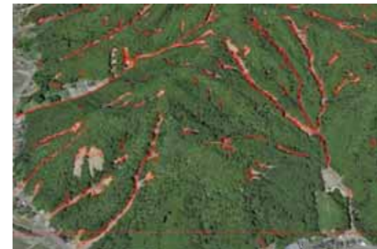
図4 航空写真+レーザー測量データによる崩壊位置の抽出例
