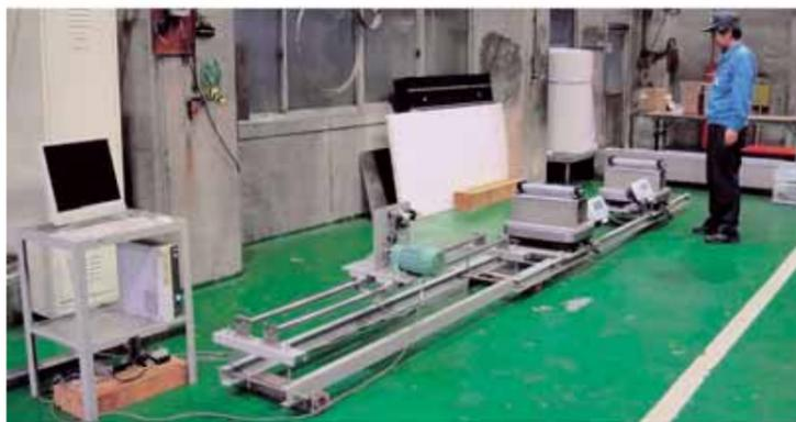
図5 改良されたWoodFFTシステムの第1号機種(株神戸工業試験場、播磨町)
