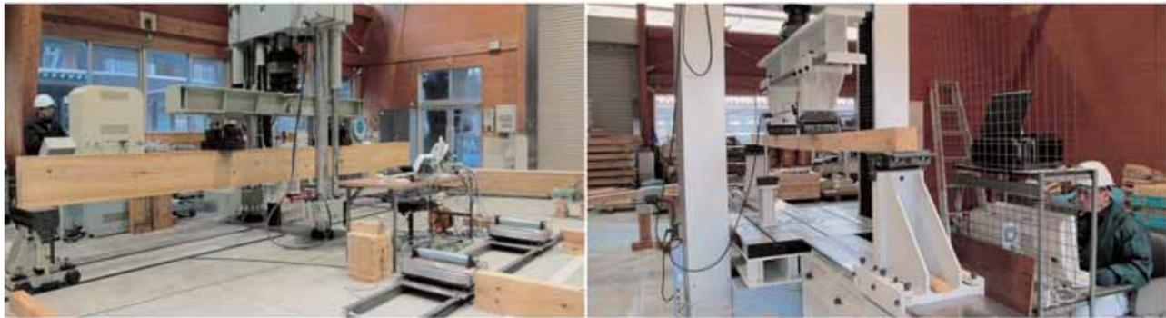
図2 材料試験機による静的曲げ試験
