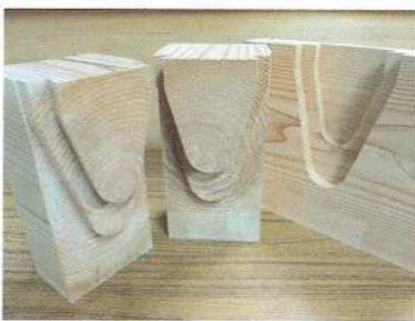
スギ材の横架材への利用拡大を図る仕口形状 Tajima TAPOS®
