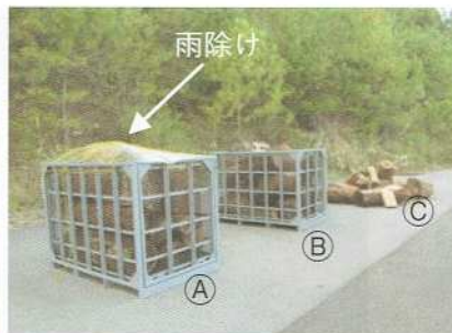
図2 試験状況 (A)コンテナ(雨除けあり) (B)コンテナ(雨除けなし) (C)山積み(雨除けなし)
